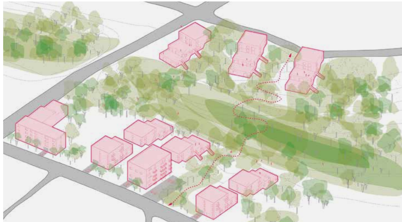
Illustration réalisée par l'agence Magnum : coupe de l'implantation du bâti dans la pente des vallons, en balcon afin de conserver les vues sur le paysage.
